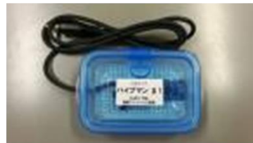
④視線入力の 振動フィードバック装置 (島根大学 伊藤史人氏)
