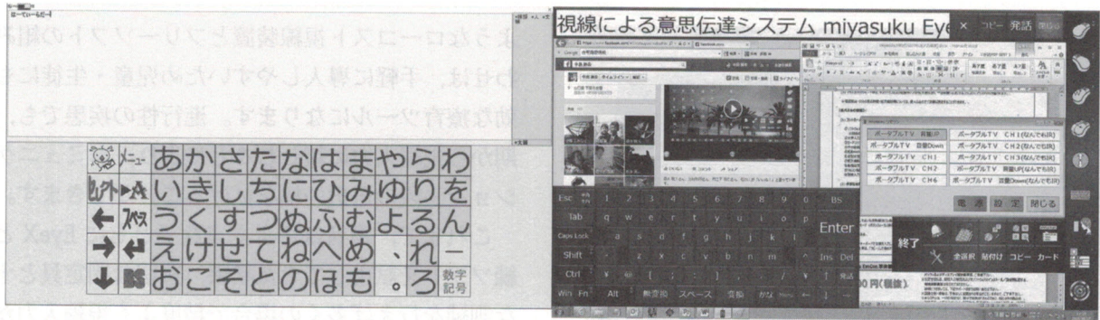
図8 視線入力ソフト (左:ハーティラーダー・右: miyasuku EyeCon)
