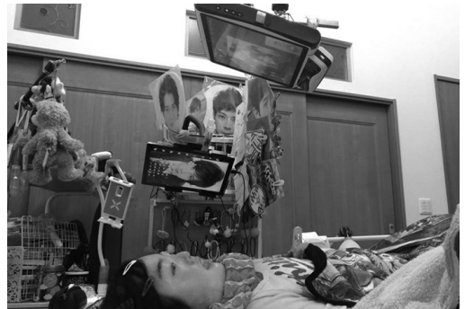
写真7 視線入力装置の固定例（左：ユニバーサルアームにノートPCを取りつけ、右：マイトビーと専用アームスタンド）
